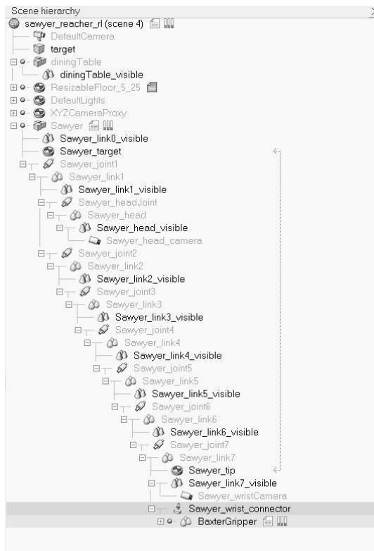
图 16.5 CoppeliaSim (V-REP) 中任务场景的层级，包括 Sawyer 机械臂在内的所有物理模型。红色箭头表示用于端点控制模式的反向运动学链。黑色字体表示场景中可见的物体，而灰色字体表示不可见的虚拟物体
